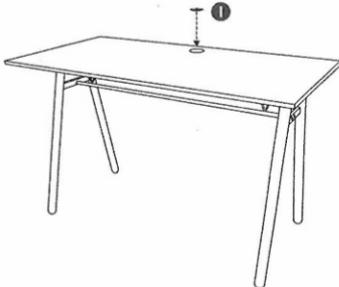
STEP 4 再將二支腳座的螺絲鎖進對應螺絲孔到底。
