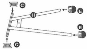
STEP 2 桌面反放，將二支腳座半固定鎖進對應螺絲孔，螺絲先不要轉到底。
